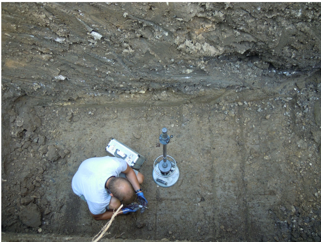
Slika 10: Meritev z dinamično ploščo z lahko padajočo utežjo v razkopu SR 2.
